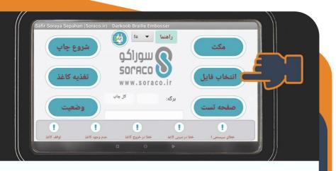
إمكانية الطباعة دون الحاجة لجهاز كمبيوتر: يمكن للمستخدم نسخ الملفات المحولة إلى طريقة برايل على ذاكرة الفلاش و توصيلها بالجهاز و متى أراد، دون الاتصال بالكمبيوتر، يصدر الأمر بطباعة الملف و الصفحة المطلوبة فقط من خلال لوحة الجهاز.
